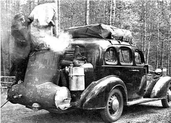
Auto met houtgasinstallatie
